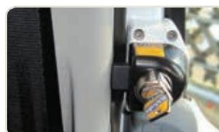
Diebstahlschutzschlösser für Fahrerhaustüren / Security lock for driver's cabin doors
